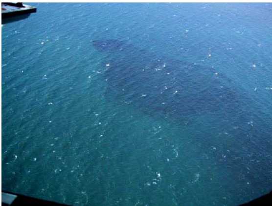
Figura 2. Fotografia obtida a sul do emissário mostrando a pluma com forma de leque.
