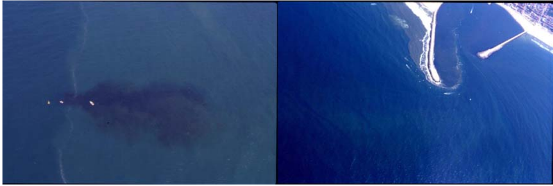
Figura 4. Fotografia obtida sobre o emissário mostrando a pluma em dispersão para nascente (terra). Fotografia do canal da barra onde se observam filamentos avermelhados sem ligação directa com a pluma do emissário.
