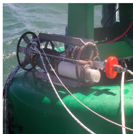
Figura 4-5 - Suporte com Equipamento do Sistema de Monitorização da Qualidade de Água
